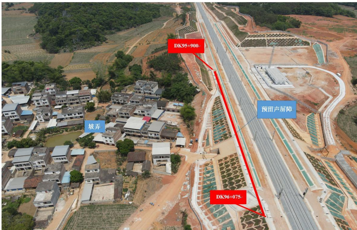
12、坡弄：DK95+900~DK96+075路基右侧设置175m高3m声屏障
